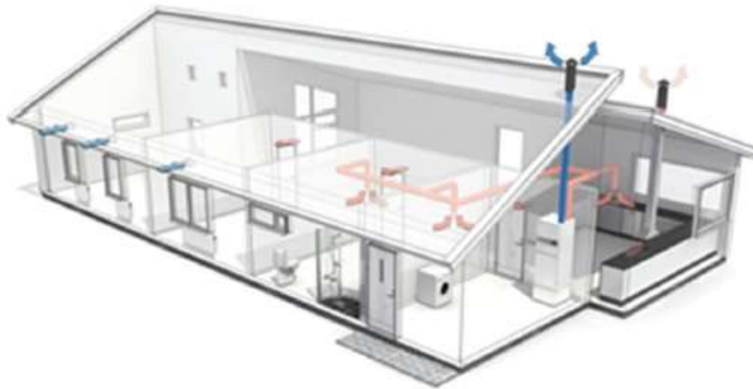
Slika 25: Prezračevalna toplotna črpalka
