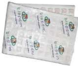
Slika 7: Makroenkapsulirani organski PCM 26
